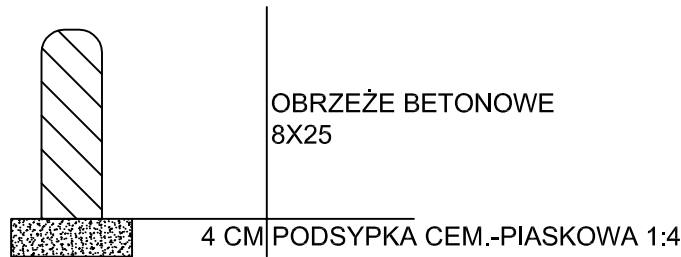
6. Obrzeże betonowe 8x25 układane na podsypce
