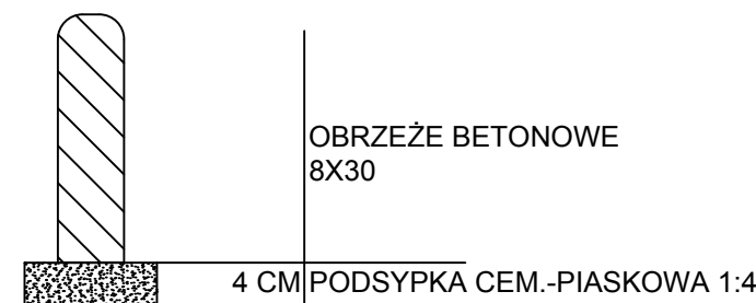
9. Obrzeże betonowe 8x30 układane na podsypce
