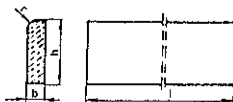
Rysunek 1. Kształt betonowego obrzeża chodnikowego
